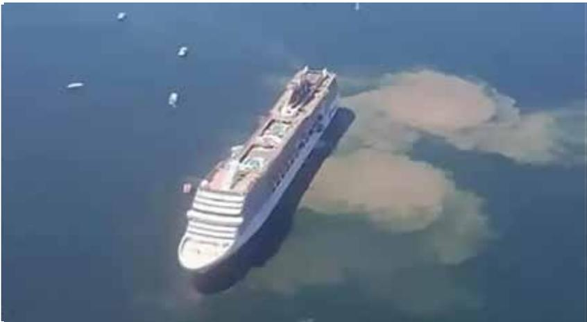
**Figure 7.** Turbulences et turbidité engendrées par les propulseurs d'un navire de croisière (Living with Harmony, 2020).
