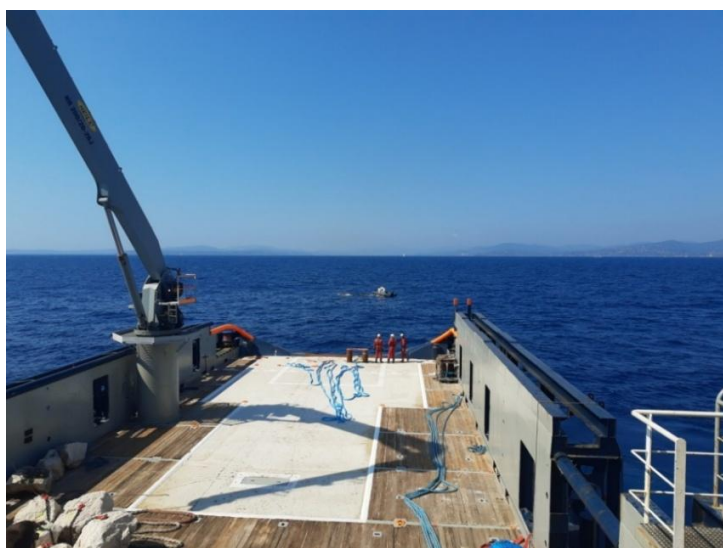
Figure 6. Dispositif Immercet en cours de déploiement au large du golfe de Saint-Tropez. Au premier plan à gauche, les blocs calcaires disposant d'anneaux métalliques scellés, manilles et chaînes. Sur la plage arrière du Pionnier , les bouts de remorquage prépositionnés. A l'arrière-plan, le semi-rigide du GPD (Groupe de plongeurs démineurs) au contact de la carcasse du cachalot. Photo © Parc national de Port-Cros.
