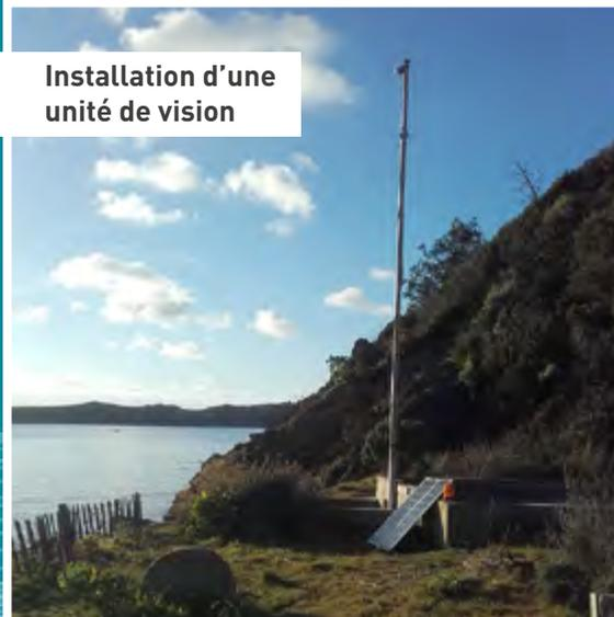
Une autonomie importante grâce à des panneaux solaires et à un système de gestion de l'énergie.
